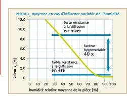
En hiver, INTELLO freine voire empêche la pénétration d'humidité dans le toit et les murs, grâce à une valeur s<sub>d</sub> supérieure à 10 m (transport d'humidité inférieur à 7 g/m<sup>2</sup> par semaine). En été, le frein-vapeur laisse alors s'échapper la vapeur d'eau. La valeur s<sub>d</sub> de 0,25 m garantit un transport d'humidité supérieur à 500 g/m² par
