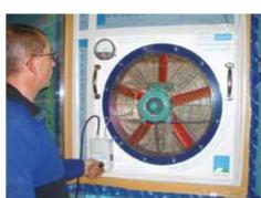
Lorsque l'étanchéité à l'air de tous les raccords est achevée, la structure d'isolation thermique bénéficie d'une protection durable. Nous recommandons de contrôler l'étanchéité à l'air avec un appareil BLOWER DOOR ou pro clima WINCON.
